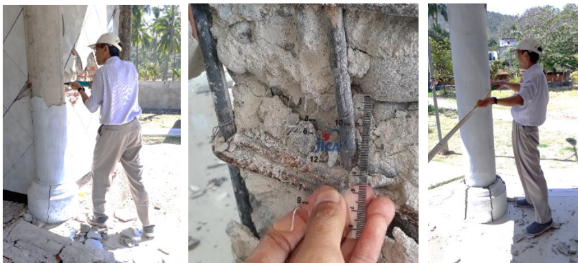
Gambar 17.3 Pengukuran kuat tekan beton dengan hammer , pengukuran dimensi tulangan, dan pengukuran dimensi struktur.
