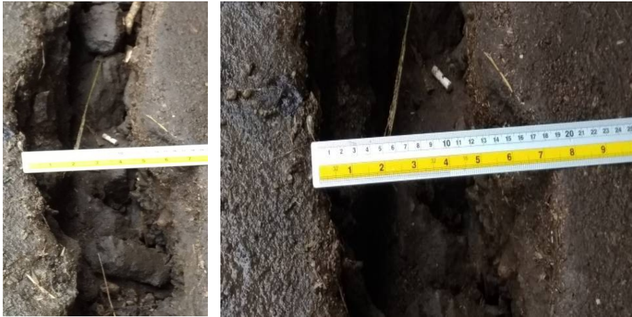
Gambar 15.24 Pengukuran lebar retakan pada puncak bendungan Jago.
