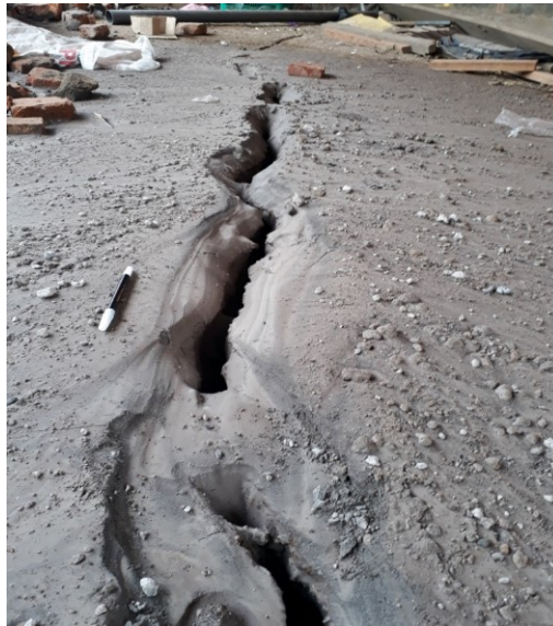
Gambar 6.4 Jejak likuifaksi ( liquefaction ), retakan tanah yang disertai dengan keluarnya air bersamaan dengan lumpur.
