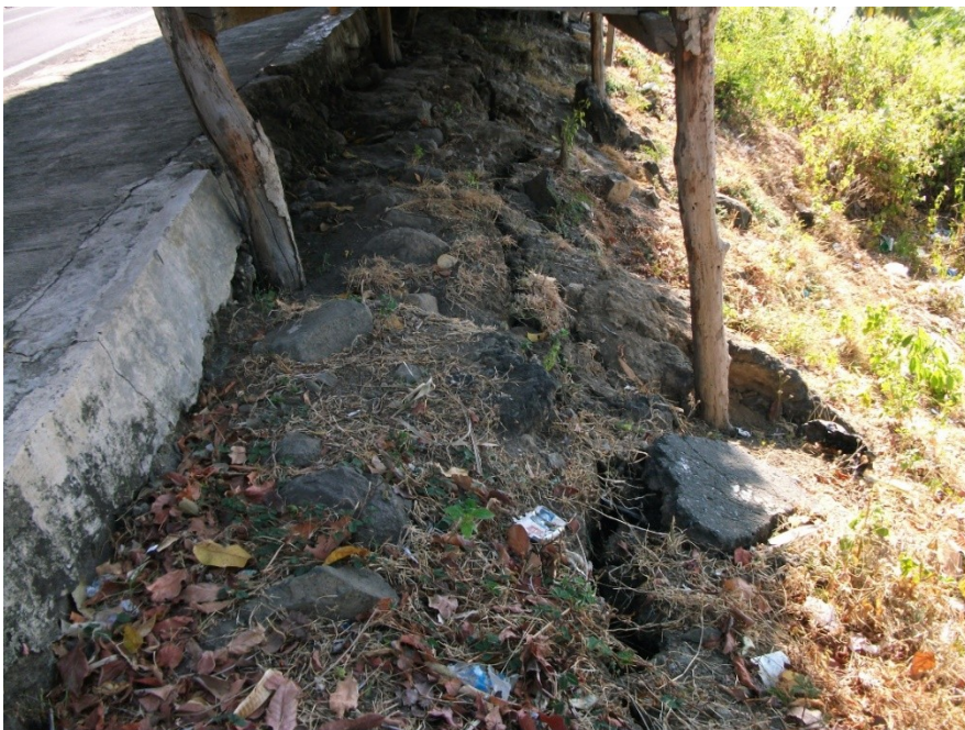
Gambar 8.16 Retakan tanah mengarah ke lembah akibat kejadian gempa tanggal 5 Agustus 2018. Retakan tanah ini berpotensi menjadi bidang gelincir gerakan tanah bila dipicu curah hujan melalui retakan tanah yang terbentuk.
