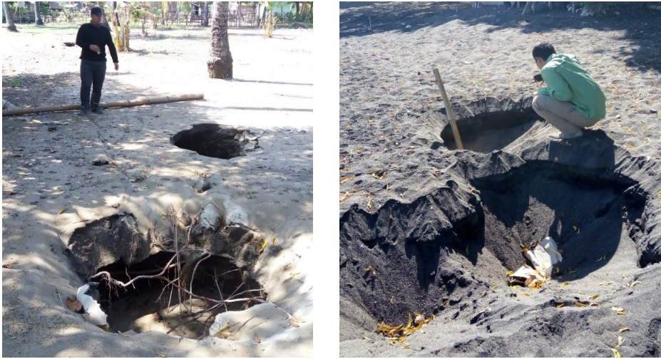
Gambar 6.5 Lubang-lubang hasil likuifaksi yang banyak dijumpai di daerah sekitar pantai. Lubang yang terbentuk di tepi pantai cenderung membentuk kerucut terbalik (kanan).
