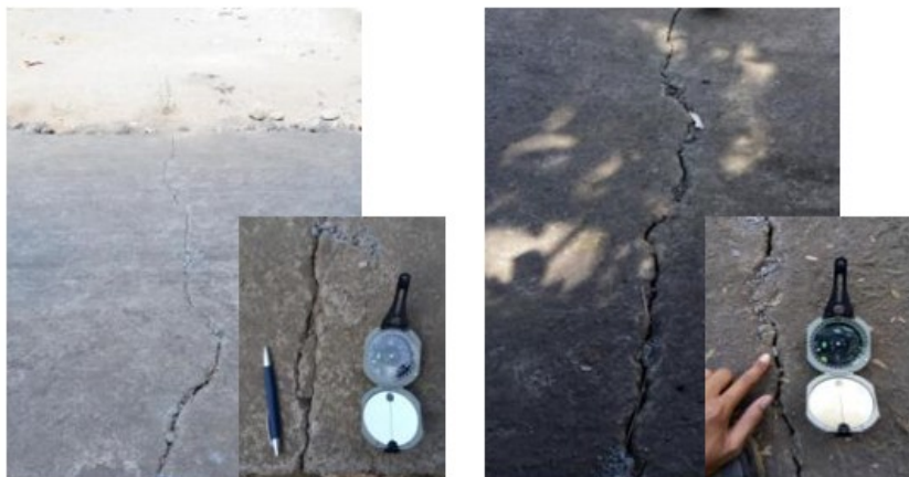
Gambar 7.5 Retakan tanah yang teridentifikasi di wilayah Dusun Malempo, Desa Obel-obel, Kecamatan Sambelia, dengan arah retakan pada N85oE dan N110oE.
